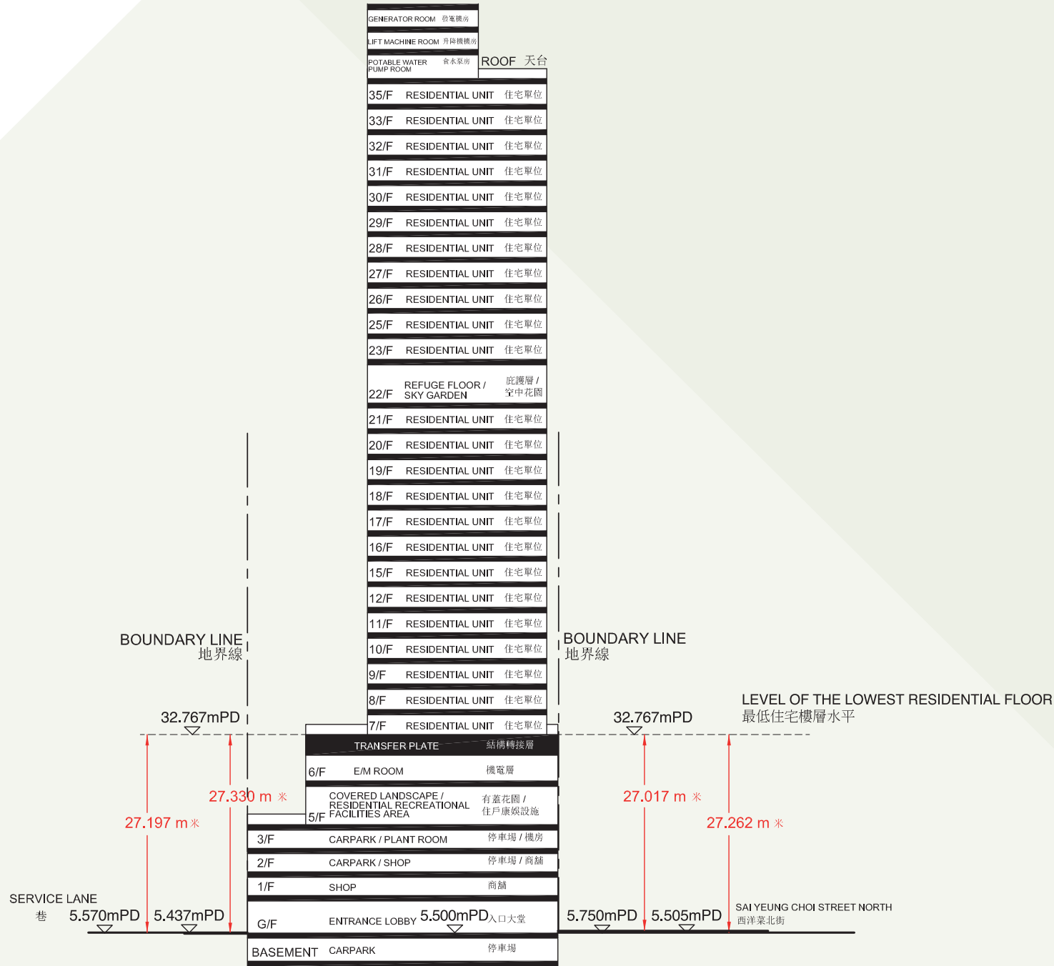
橫截面圖 B-B Cross - Section Plan B-B
